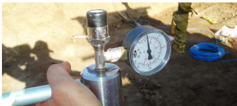
Saturación del filtro HAE con dispositivo de saturación
