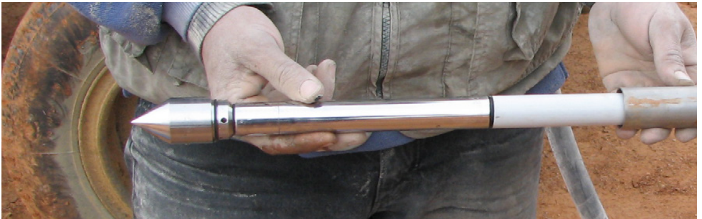
Piezómetro Drive-in con varilla push-in
